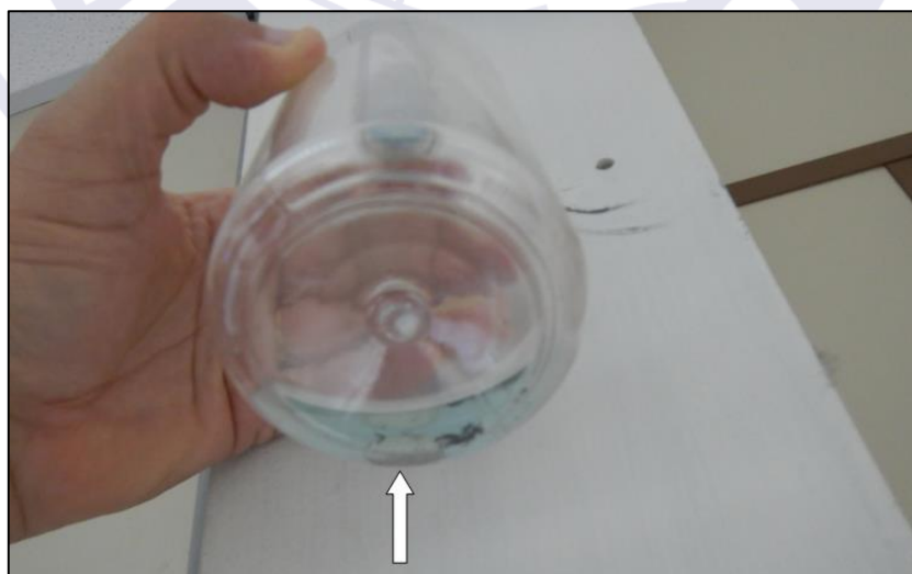
Figura 3 - Combustível retirado da cuba do carburador, indicando a presença de água.
