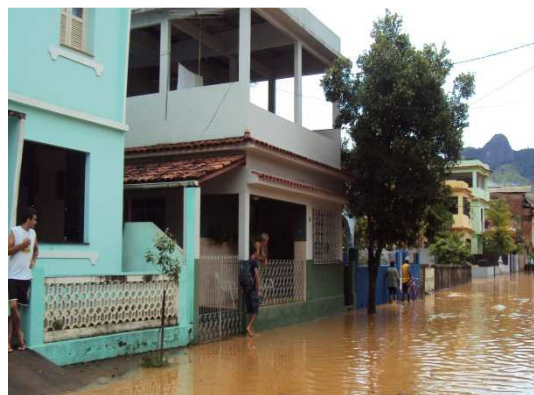
Figura 4-23: Rua Clarindo Vivas. Bacia do Córrego da Serra. Casas acima do nível da rua para evitar alagamentos.
